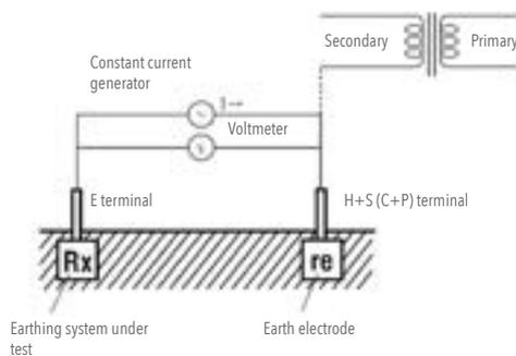
La résistance « $re$ » de l'électrode existant auquel est connecté la pince  $H+S(C+P)$ , est ajoutée à la résistance réelle « $R_x$ » de l'objet mesuré et affichée comme résultat de mesure.
