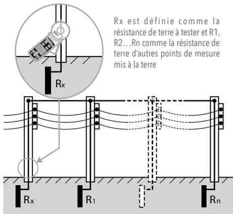
$R_x$  est définie comme la résistance de terre à tester et  $R_1, R_2, \dots, R_n$  comme la résistance de terre d'autres points de mesure mis à la terre
