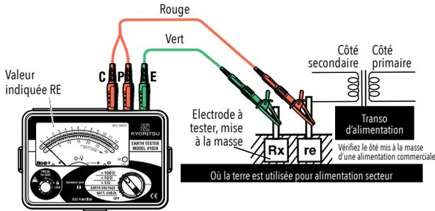
Mesure précise (avec cordon de mesure 7095)
