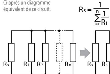
La tension  $V$  est appliquée à l'objet à mesurer (résistance  $R_x$ ) à partir du transformateur de tension  $CT1$  et le courant  $I$  en fonction de la résistance de terre est généré. Le courant  $I$  est détecté par un transformateur de détection  $CT2$  et l'objet (résistance  $R_x$ ) mesuré peut être défini moyennant un calcul (voir diagramme).
