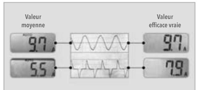
De par l'utilisation de thyristors, d'inverseurs et d'autres régulateurs d'énergie dans le câblage électrique actuel, des formes d'ondes de courant contiennent souvent des composants harmoniques et sont déformées en comparaison avec les ondes sinusoïdales (50/60Hz).
