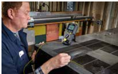
Comprend une entrée de thermocouple de type K pour les mesures thermiques
