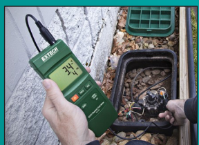
Mesure de la sortie du champ magnétique CA d'un système de relais d'arrosage
