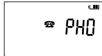
Répondeur détecté à l'extrémité éloignée du câble
