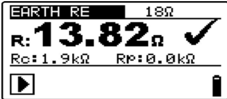
Figure 5.35: Exemple de résultat de mesure de résistance de terre
