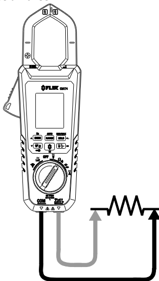
Figure 5.5 Mesure de résistance et de continuité
