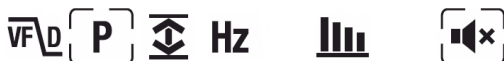
Fig. 5.2 Icônes de mode (mesure de tension c.a.) : dans ce cas-ci, les modes « Crête » et « Silence » sont activés.
