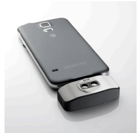
Figure 31.3 2015 : l'accessoire FLIR One pour iPhone et téléphones mobiles Android. Poids : 90 g.
